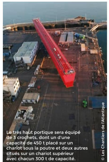
Le très haut portique sera équipé de 3 crochets, dont un d'une capacité de 450 t placé sur un chariot sous la poutre et deux autres situés sur un chariot supérieur avec chacun 300 t de capacité.
