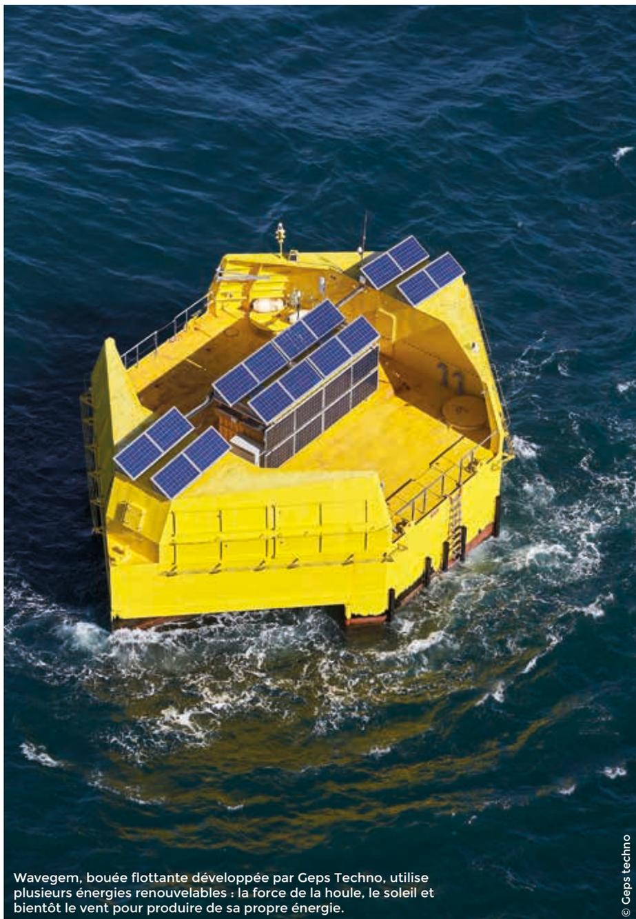
Wavegem, bouée flottante développée par Geps Techno, utilise plusieurs énergies renouvelables : la force de la houle, le soleil et bientôt le vent pour produire de sa propre énergie.
